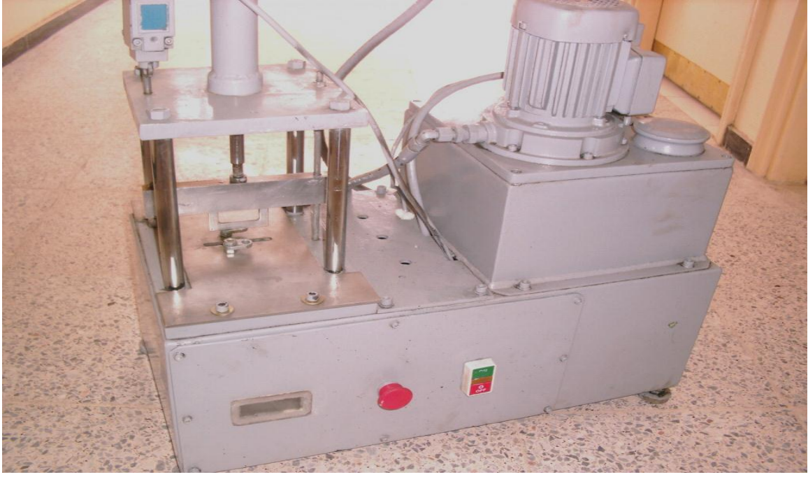
شكل (٣-b): جهاز قص اللحوم الهيدروليكي موضحاً "فيه سكين القص".
